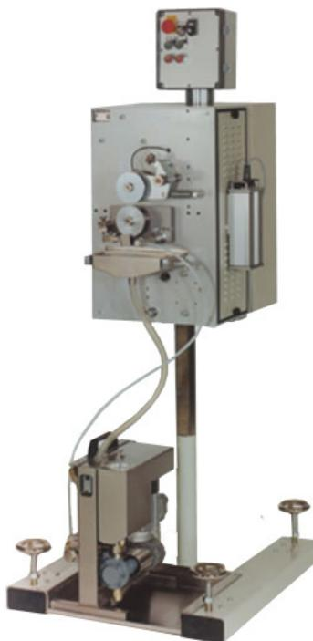
Высокоскоростной прибор глубокой печати с одинарной маркирующей головкой для печати по горячей изоляции кабелей.
