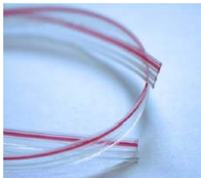
Рис.7 Лента из 4-х пластиковых оптических волокон (POF)
