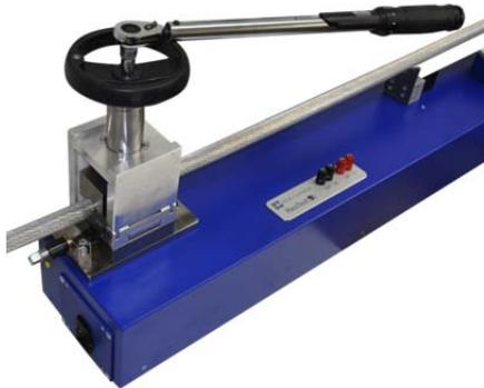
Динамометрический ключ позволяет легко задать одно и то же усилие при сжатии
