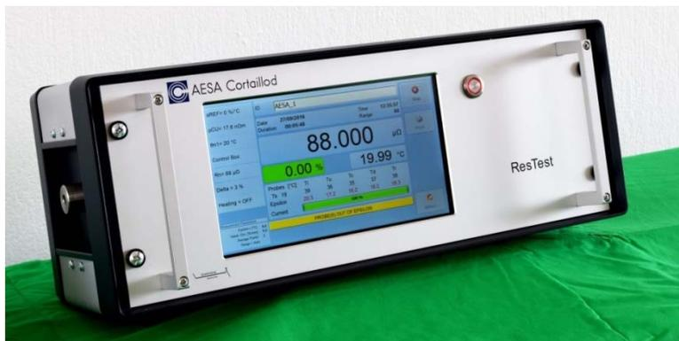
На передней панели расположен экран и кнопка подсветки, показывающая состояние измерения. Эта кнопка предназначена специально для того, чтобы в производственных условиях оператор мог легко начать/остановить измерение.
